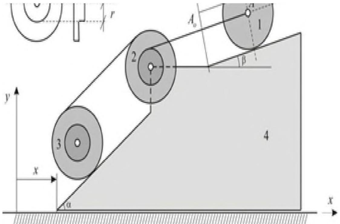
внутренним радиусом  $r_2 = r_3 = r$  и наружным радиусом  $R_2 = R_3 = 2r$ . Даны моменты инерции цилиндров:  $J_1 = J_2 = J_3 = \frac{1}{2} m r^2$ .
